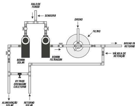
Quando fizer a filtragem da piscina, além das manobras de registros, deve-se desligar a motobomba do sistema de aquecimento solar.
